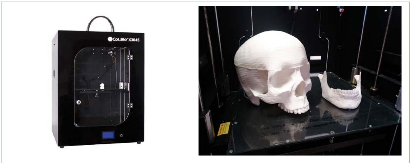
Figura 4. Impresora modelo Colido X3045 utilizada para la fabricación aditiva de las piezas craneales.
